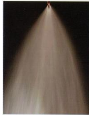
Simulation d'une application herbicide avec adjuvant. Vent latéral 7.5 km/h
