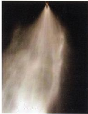
Simulation d'une application herbicide sans adjuvant. Vent latéral 7.5 km/h
